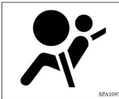
La luz de bolsa de aire de seguridad auxiliar se muestra como
