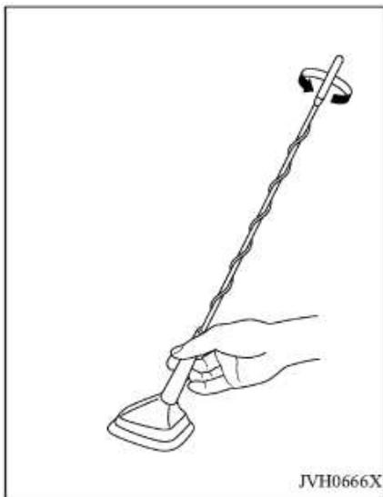
La antena se puede desmontar cuando sea necesario.
