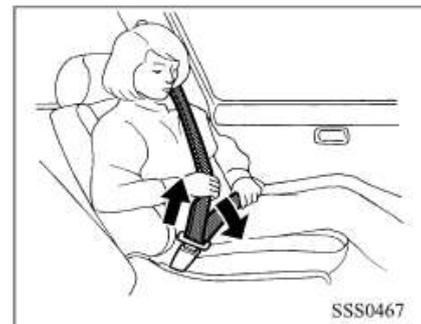
3. Como se muestra en la figura, pegue el cinturón de seguridad de cintura firmemente en la parte inferior de la cadera.
